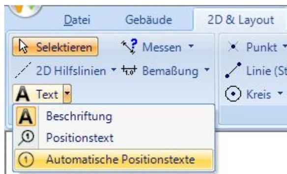
Nach dem Start erscheint automatisch der Dialog Positionstexte mit der Auswahl der Folien, für die die Texte erzeugt werden sollen sowie der Auswahl der Elemente Wände, Fenster und Fensterkonstruktionen.
